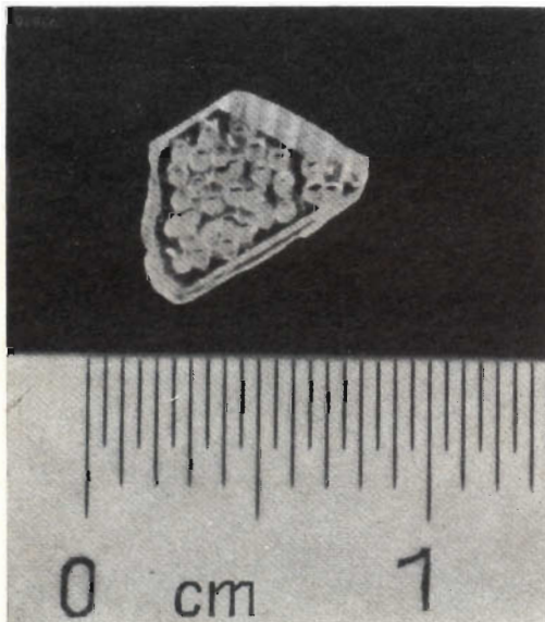
Fig. 3 - Placchetta di diamante di 1,6 mm di spessore tagliata parallelamente al piano (111) dalla quale sono stati ricavati i cilindretti di 0,3 mm di diametro che serviranno alla fabbricazione delle puntine.
