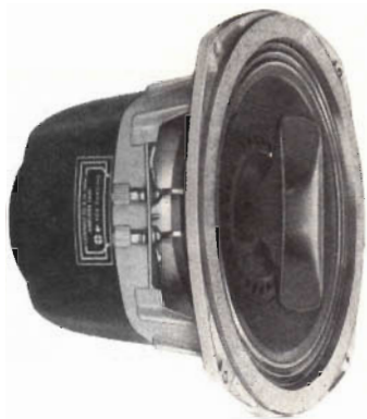
Altoparlante triassiale (modello University 308). Si vedono molto bene il tweeter a tromba ed il cono per le medie frequenze, unito al cono principale per le basse frequenze attraverso un anello flessibile ricavato nella membrana.
